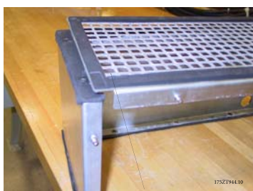
Disegno 3.41: La guarnizione sporge dal bordo per assicurare la tenuta tra il condotto e il coperchio ventilato dalla parte superiore
