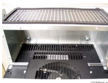
Disegno 3.42: Condotto superiore installato
