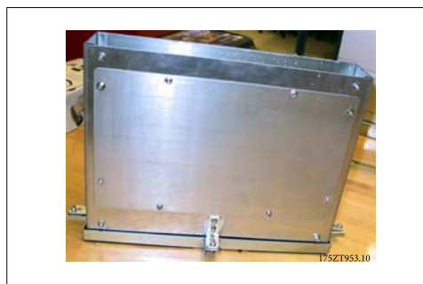
Disegno 3.53: Gruppo condotto inferiore completamente assemblato
