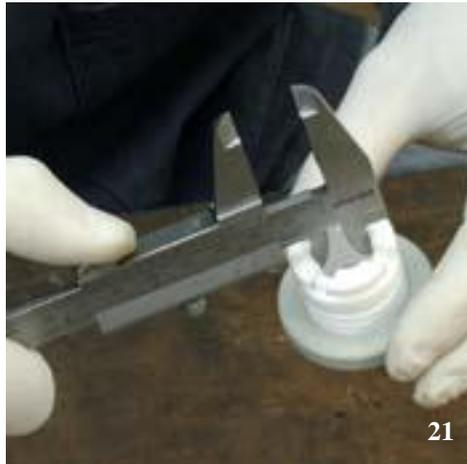
**Controllare il Ø dell'albero pompa (17):**
