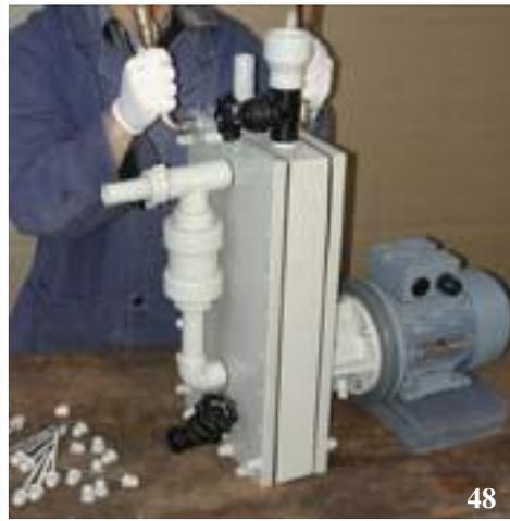
**Assemblare lo scudo posteriore (62) al corpo della camera di adescamento (63) - con entrambe le guarnizioni (68) - e allo scudo anteriore (64).**
