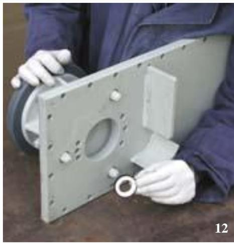
Sfilare l'anello statico (31) e il sedgio (32), solo se deteriorati, agendo dalla parte posteriore del castelletto motore (01).
