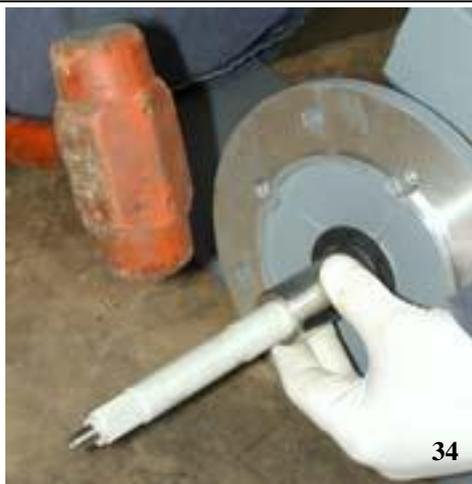
**ATTENZIONE:** se, invece del truschino, viene usato un comparatore, il valore dello scostamento finale deve essere  $0,01 \pm 0,03$  mm.
