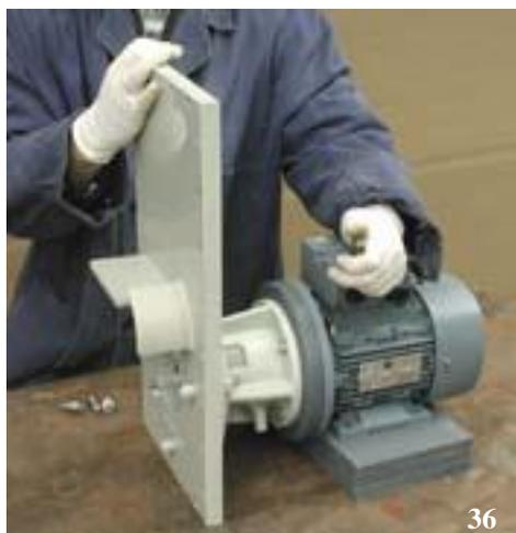
Rimuovere con alcool ogni residuo solido o di olio dall'anello statico (31), dall'esterno della sua sede e dall'albero pompa (17). Verificare che il rivestimento plastico dell'albero (17) non presenti rigature o deformazioni.
