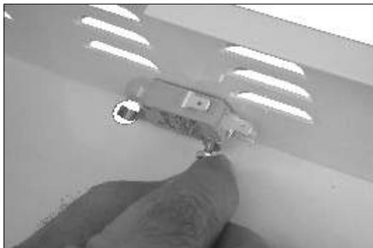
a) Inserire lo switch di tamper nell'apposito perno predisposto sul contenitore della centrale, avvitando il dado in dotazione e facendo attenzione affinché lo switch possa ruotare liberamente;
