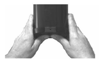
Per rimontare il coperchio, inserirlo con la parte bassa qualche cm sotto il piattello inferiore in modo che si posizioni nelle guide del profilato d'alluminio che costituisce l'incastellatura, spingere il coperchio dal basso verso l'alto, in modo che scorrendo nelle guide si inserisca nel piattello superiore, poi avvitare la vite di fissaggio.
