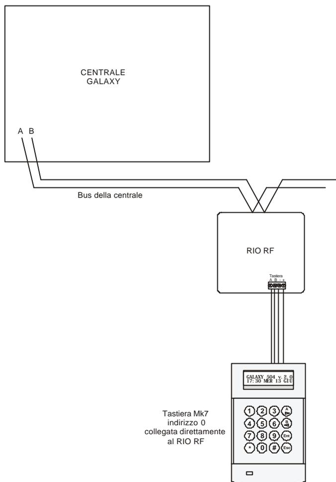
**Figura 1-2: Architettura del RIO RF**
