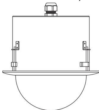
Questo adattatore è stato progettato per montare speed dome PTZ a controsoffitto. Per l'installazione è necessario munirsi di un cacciavite e un cutter. Tre ganci di montaggio sono pre-assemblati per un effettivo fissaggio della custodia al controsoffitto.
