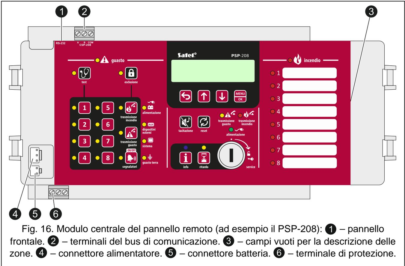
Fig. 16. Modulo centrale del pannello remoto (ad esempio il PSP-208): ① – pannello frontale. ② – terminali del bus di comunicazione. ③ – campi vuoti per la descrizione delle zone. ④ – connettore alimentatore. ⑤ – connettore batteria. ⑥ – terminale di protezione.
