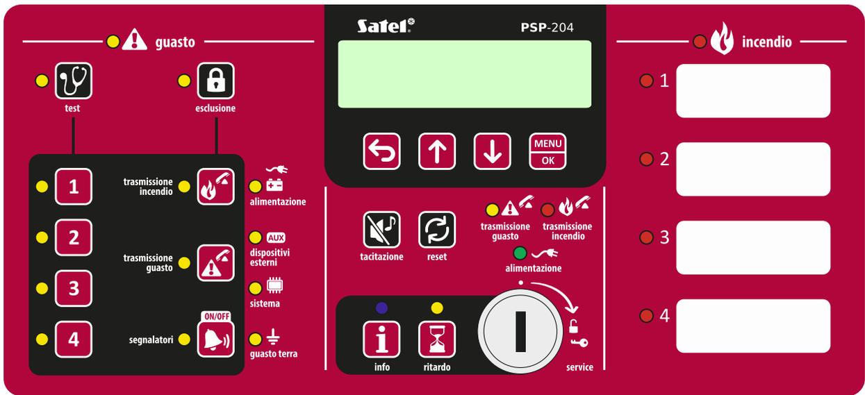
Fig. 18. Pannello frontale del pannello remoto PSP-204.
