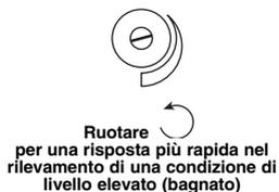
**Regolazione flusso elevato (High Level Fail-safe)**
