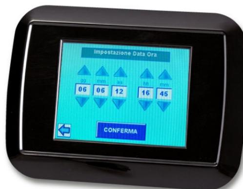
Qualora il SILFAB ENERGY STATION non fosse connesso ad Internet, la regolazione dell'ora sul SILFAB ENERGY STATION VIEW può essere effettuata sulla apposita maschera di "Impostazione data ora". In caso di blackout o di interruzione di alimentazione al SILFAB ENERGY STATION sarà necessario reimpostare nuovamente l'ora. Senza l'impostazione dell'ora il SILFAB ENERGY STATION non memorizza i dati storici dell'impianto.
