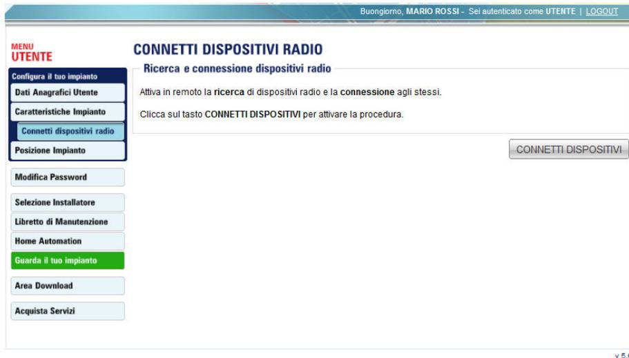
Cliccare sull'icona "CONNETTI DISPOSITIVI" per avviare il processo di accoppiamento. Il tempo necessario al processo dipende dalla frequenza di Connessione WEB.
