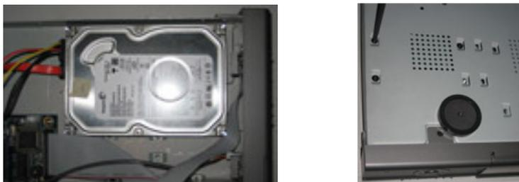
5. Bloccare l'HDD con le viti di fissaggio come in figura.
