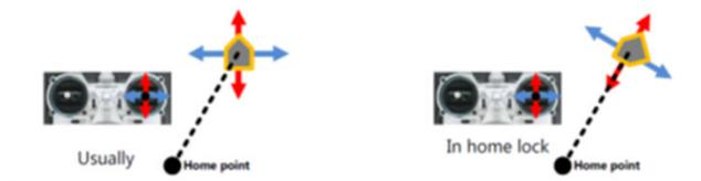
Prima di usare questa funzione dovete selezionare sulla vostra radio un canale con un interruttore a 2 o 3 posizioni per il controllo dell' IOC. Quindi collegate il cavo del canale selezionato all'ingresso X2 della MC. Ricordarsi di settare i fine corsa del comando dalla radio , muovete il canale X2 tra Home Lock , Course Lock, OFF al fine di evidenziare rispettivamente e correttamente le aree in Blu.
