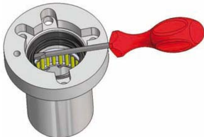
Figura 36. Rimozione degli anelli di tenuta
