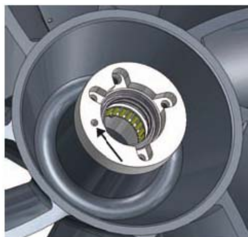
Figura 33. Estrazione della cassa del cuscinetto posteriore
