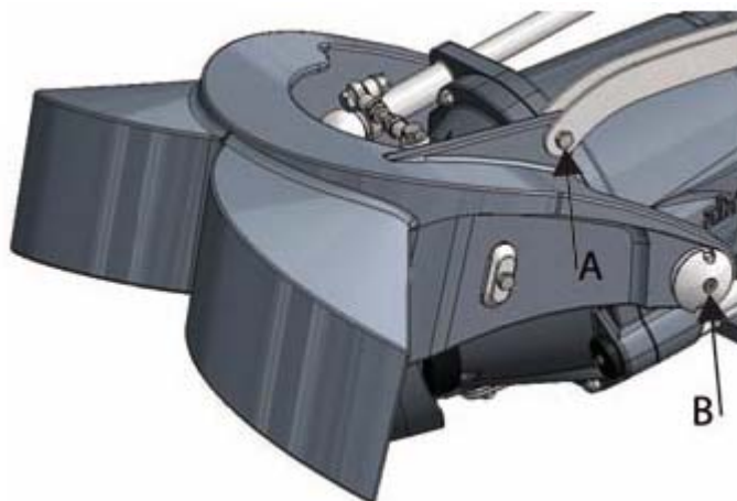
Figura 54. Smontaggio del deflettore
