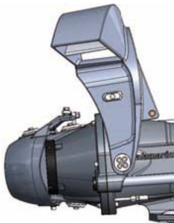
Figura 80. Deflettore completamente sollevato
