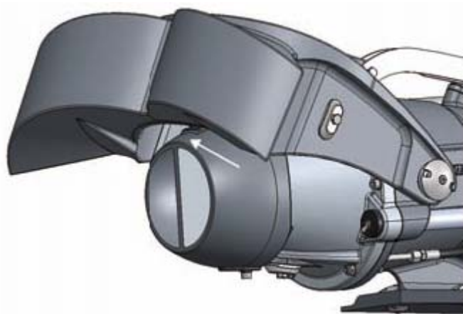
Figura 72. Deflettore in posizione alta
