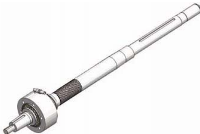
Figura 7. Cassa del cuscinetto, albero, cuscinetti e tenuta meccanica
