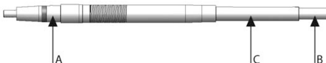
Figura 14. Misure da effettuare per verificare che l'albero sia dritto
