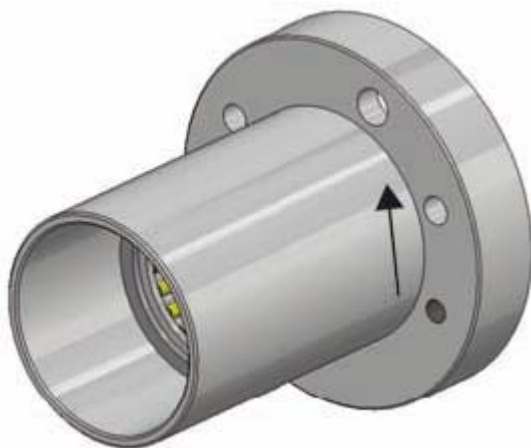
Figura 40. Superficie su cui spalmare materiale sigillante
