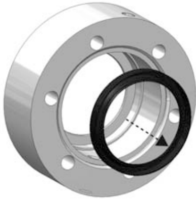
Figura 12. Tenuta dell'albero sulla cassa del cuscinetto
