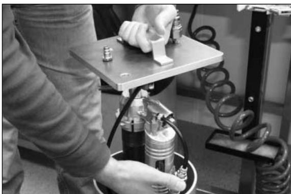
– Abbassare l'ammortizzatore nel serbatoio supplementare facendo attenzione a non danneggiare il bordo superiore del cilindro per assicurare la tenuta del serbatoio. Un danneggiamento del bordo superiore può portare alla perdita della tenuta e rendere inefficace la stazione di vuoto e carica. Inserire il tubo con cautela nel serbatoio facendo attenzione a non piegarlo.
