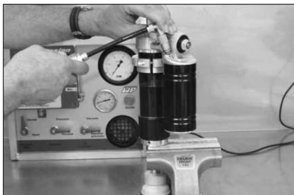
– Svitare il raccordo dall'apertura di riempimento dell'ammortizzatore.
