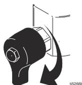
Se si sospetta che l'ugello di spruzzatura o il flessibile siano ancora ostruiti o che la pressione non sia stata del tutto scaricata dopo aver seguito questi passaggi, allentare il dado di ritenzione della protezione dell'ugello o il raccordo dell'estremità del flessibile **molto lentamente** per scaricare gradualmente la pressione. Quindi allentare del tutto.
