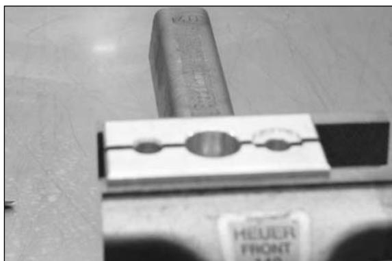
– Inserire il blocco di serraggio T 14.016 nella morsa.
