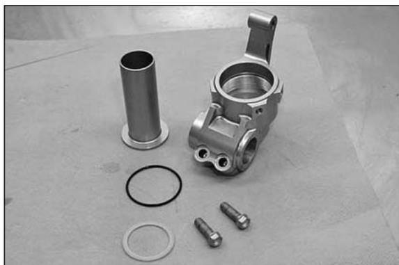
– Piede portaruota con i singoli componenti.
