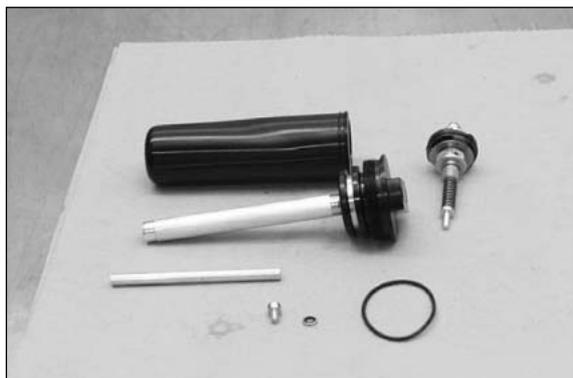
– Il tappo a vite e la membrana CC con i singoli componenti.
