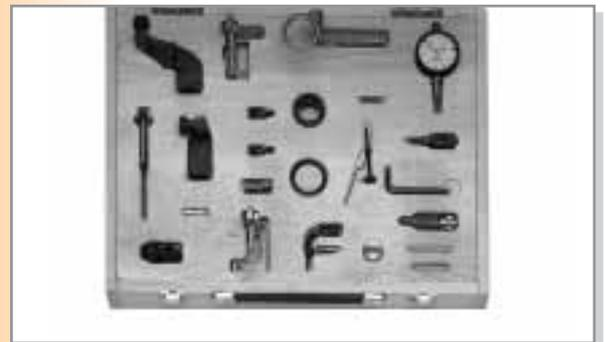
**4657** Cassetta attrezzi messa in fase pompe iniezione - DPA - DPC - DPS - Roto Diesel - Bosch - VE - VA
