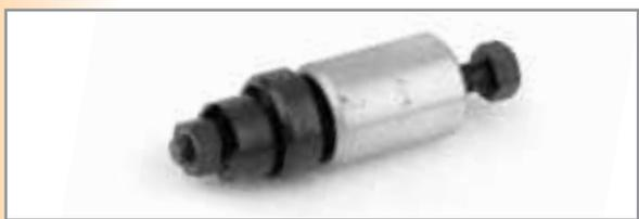
Estrattore introduttore silentbloc sostegno motore superiore
