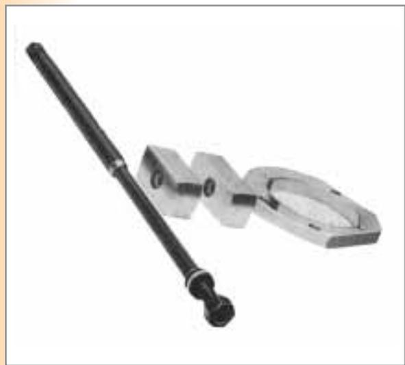
Estrattore ed introduttore canne cilindri 684-160-697 ecc.
