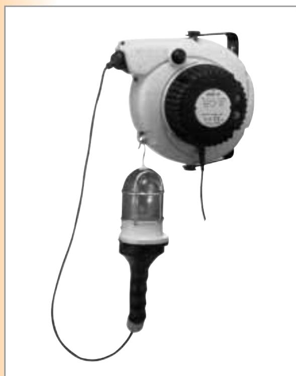
**6866** Avvolgimento automatico con lampada e trasformatore. Viene fornito con 15,5 m di cavo sezione 2x1 mmq con tensione alimentazione di 230 volt, tensione di uscita 12 e 24 volt
