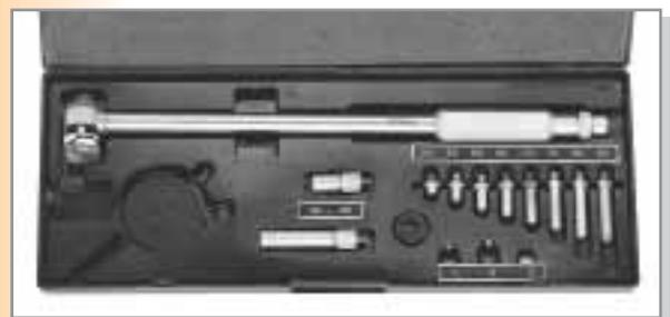
Calibri con comparatore per la misurazione del diametro delle canne cilindri
