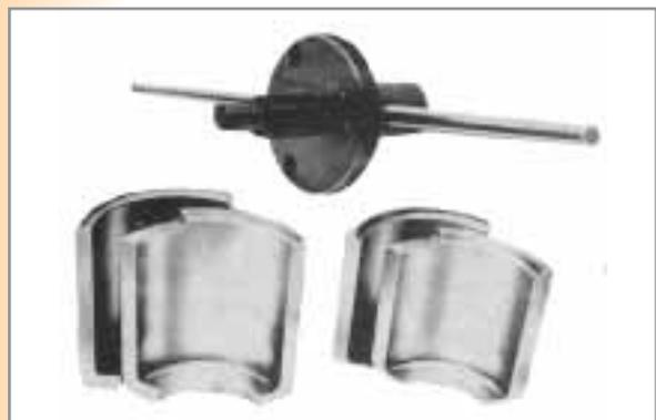
Estrattore per accoppiamento conico pignone cilindrico - corona V.I. 684-160-170-690
