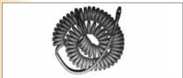
Tubi a spirale in poliretano con attacchi. Le spirali possono essere utilizzate da -40°C a +80°C ma possono essere usate per qualsiasi applicazione pneumatica non superiore a 10 bar.
