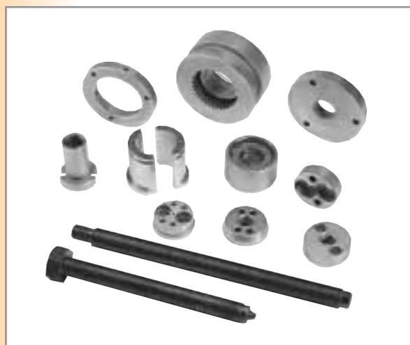
Attrezzatura completa per smontaggio e rimontaggio rallentatore
