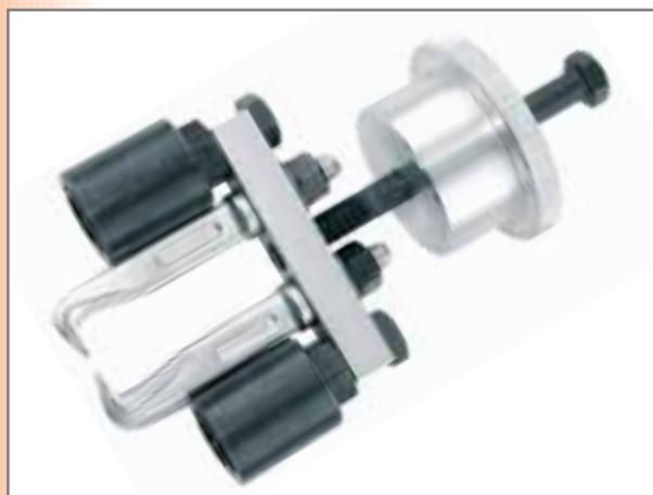
**4995** Estrattore a battitoio per doppio porta iniettori Bosh montato su Mercedes Classe A con common rail. Il medesimo estrattore con le relative zampe può essere usato per estrarre la staffa fissa porta iniettori
