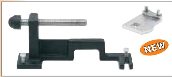
Staffa per il bloccaggio della puleggia della catena superiore onde evitare il deformarsi della spina di fasatura della pompa d'iniezione. L'attrezzo è completo di adattatore.
