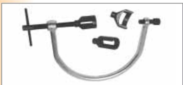
Attrezzo per montaggio e smontaggio valvole motore
