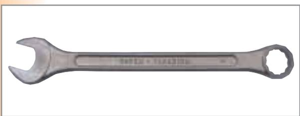
Chiave combinate da mm 18, spessore poligono mm 5 per smontaggio e montaggio cambio durante la sostituzione della frizione senza smontare la marmitta.
