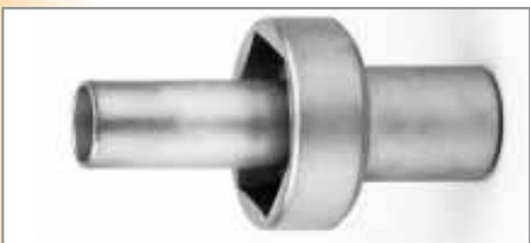
Chiave per dado bloccaggio e registro cuscinetti mozzi ruote ponti intermedio e posteriore
