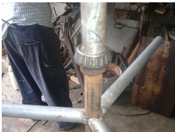
92. Cuscinetto conico a rulli solidale al corpo centrale.
