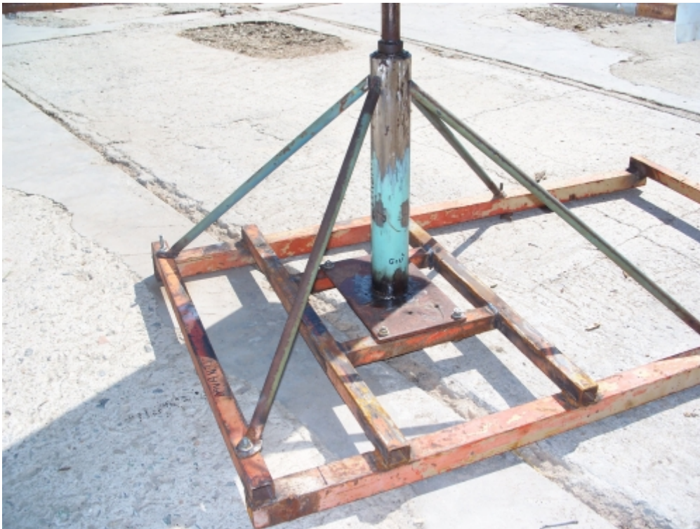
90. Statore ed ancoraggio all'incastellatura.
