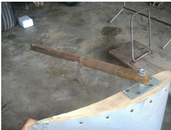
93. Particolare del serraggio dei bracci B.
