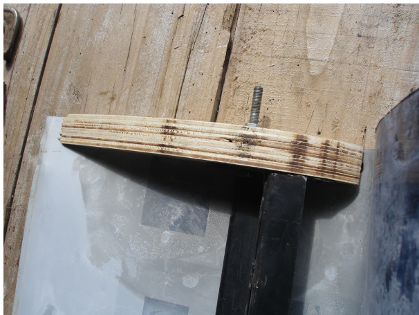
87. Vite di regolazione angolo di attacco.
