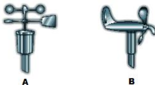
30. Anemometro a coppe (A); anemometro ad elica (B).
