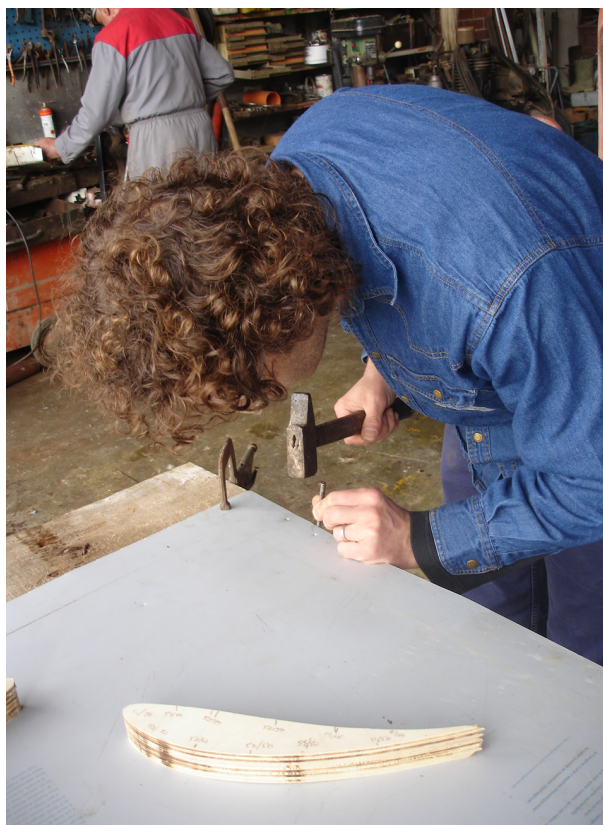
84. Foratura manuale del rivestimento.
