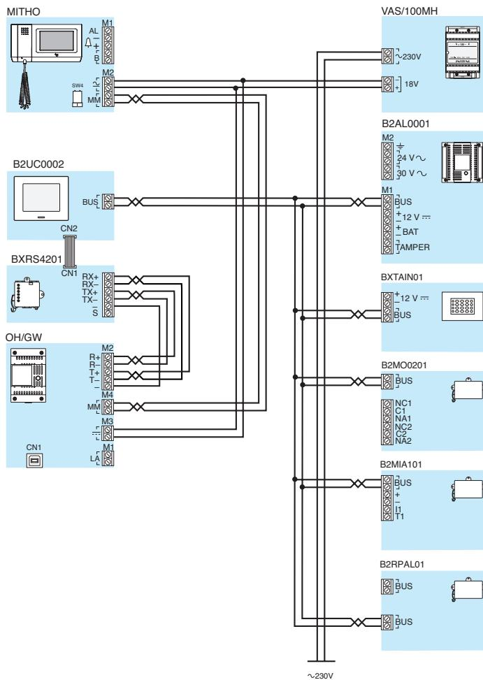
**Esempio n° 5****Installazione in impianti antintrusione C4**
