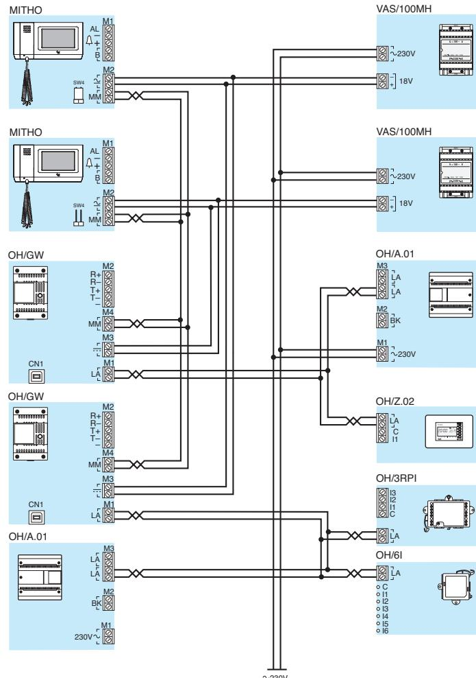
**Esempio n° 4****Installazione in impianti antintrusione B2**
