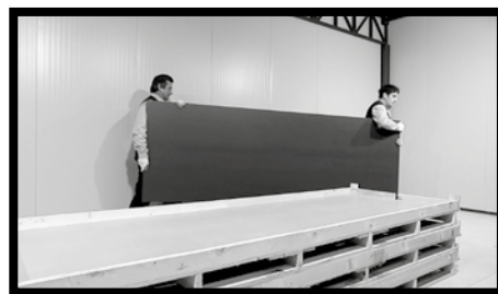
Abb.3 - Mit der Platte in vertikaler Position kann man sie an der oberen Kante haltend anheben und in gerader Stellung mit Hilfe einer zweiten Person befördern.
