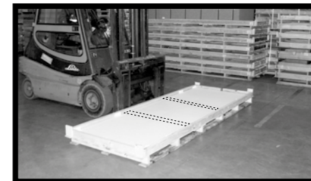
Fig.7 - Pour saisir la palette sur le côté long, écarter les fourches de 1 m au moins, et enfourcher perpendiculairement au côté long de la palette et en son milieu. Les fourches doivent prendre toute la profondeur de la palette.
