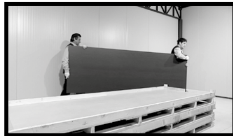
Fig.3 - Quando la lastra è in posizione verticale sollevarla sostenendola per il bordo superiore, quindi muoversi mantenendola sempre rettilinea con l'aiuto di una seconda persona.
