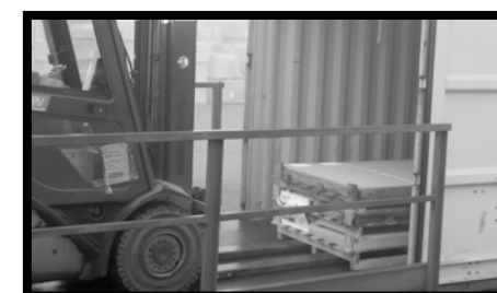
Fig.8 - Per inforcare il pallet sul lato corto (es. nello scarico dei containers) si dovrà assolutamente utilizzare forche lunghe almeno 2,5 m per una perfetta presa e sollevamento a garanzia dell'integrità del contenuto.
