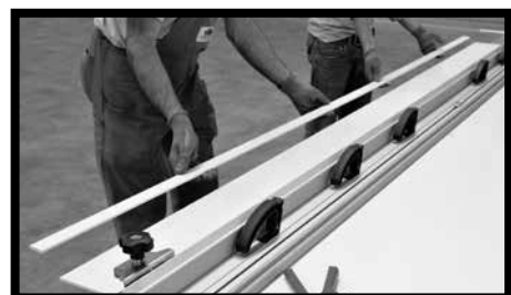
Fig.13 - Pour faciliter la découpe des carreaux, on peut s'aider d'une carrellette (modèle Keracut de Sigma ou Free-cut de Raimondi ). Dans le cas de KERLITE 3plus et KERLITE 5plus, même en utilisant une carrellette, après l'incision de la partie céramique et la division de la dalle, parfaire l'opération en découpant la fibre de verre à l'aide d'un simple cutter ( Fig. 12 ).
