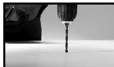
Fig.16 - En ce qui concerne le perçage manuel, il est possible d'utiliser des mèches au tungstène allant jusqu'à un diamètre de 10 mm montées sur une perceuse électrique ou une visseuse à piles.
