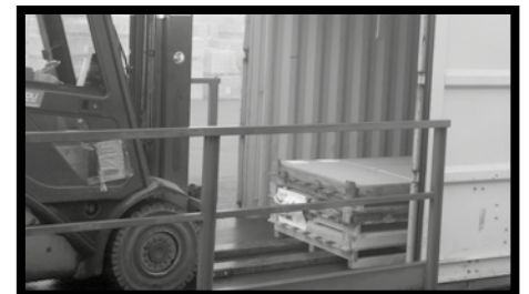
Fig.8 - Pour saisir la palette sur le côté court (par ex. à la sortie du conteneur), il faut que les fourches aient une longueur minimum de 2,5 m pour une prise et une manutention parfaites et sans casse.
