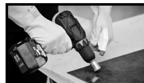
Fig.17/18 - Sinon on peut utiliser un trépan monté sur une ponceuse ou une perceuse électrique ou une visseuse à piles.
