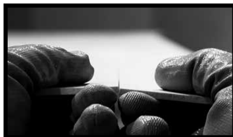
Fig.11 - Au terme de l'incision, il suffit d'exercer une légère pression pour que les deux pièces se détachent.
