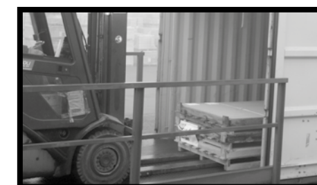
Abb.8 - Um die Palette an der kurzen Seite aufzugabeln (z.B. beim Entladen der Container) sind unbedingt mindestens 2,5 m lange Gabeln zu verwenden, damit ein perfektes Aufgreifen und Heben gesichert ist und auch der einwandfreie Zustand des Inhaltes.
