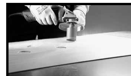
Fig.17/18 - Sinon on peut utiliser un trépan monté sur une ponceuse ou une perceuse électrique ou une visseuse à piles.
