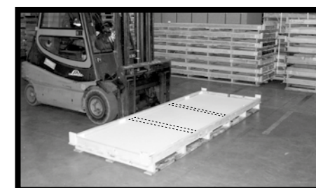
Fig.7 - Per inforcare il pallet sul lato lungo posizionare le forche ben distanziate tra loro di almeno 1 m, perpendicolarmente al lato lungo del pallet e al centro dello stesso. Le forche devono far presa su tutta la profondità del pallet.
