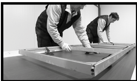
Fig.4/5 - Le lastre di KERLITE nelle sue varie tipologie nel formato 300x100 cm possono essere movimentate da due persone con l'ausilio di un apposito telaio. Fissare il telaio alla lastra quando è ancora all'interno del pallet. Quindi sollevare il telaio e la lastra per eliminare l'effetto ventosa.
