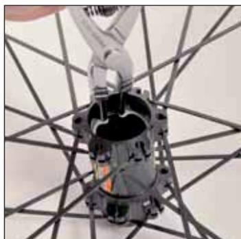
Ponendosi dal lato opposto al disco, con una pinza per circlip interni, smontate il primo circlip interno (lato opposto al disco) e poi il secondo circlip interno (lato disco)
