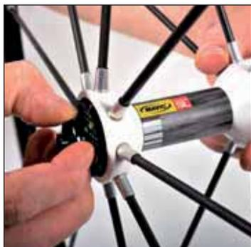
Smontate manualmente l'appoggio per forcella (agganciato sull'asse) dal lato del mozzo con adesivo
