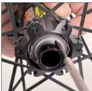
Con una pinza per circlip esterni, rimontate il circlip esterno sull'asse, lato opposto al disco. Assicuratevi del corretto posizionamento del circlip nella sua gola facendo pressione su 3 punti
