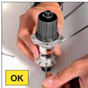
Il primo raggio sul lato opposto alla ruota libera deve posizionarsi in un alloggiamento di fronte al quale si trovi un alloggiamento sul lato ruota libera
