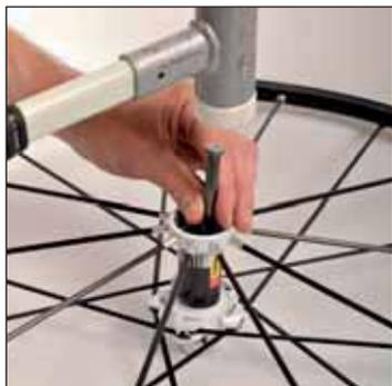
Estraete i cuscinetti utilizzando l'estrattore di montaggio / smontaggio 323 909 01
