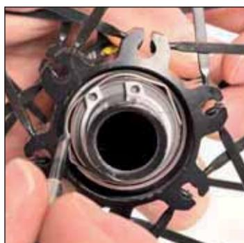
Mantenete una pressione sull'asse dal lato opposto al disco e contemporaneamente, con un cacciavite, spingete sul fermaglio in 3 punti (2 estremità + centro) per farlo scivolare verso l'interno
