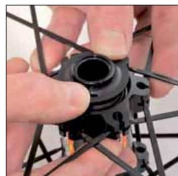
Rimontate il para-polvere spingendolo parallelamente all'asse
