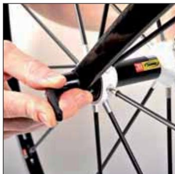
Installate il bloccaggio rapido e montate la ruota nella forcella o nel telaio e serrate il bloccaggio con una forza sufficiente
