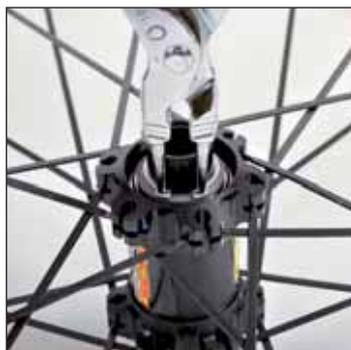
Smontate il circlip con una pinza per circlip esterni
