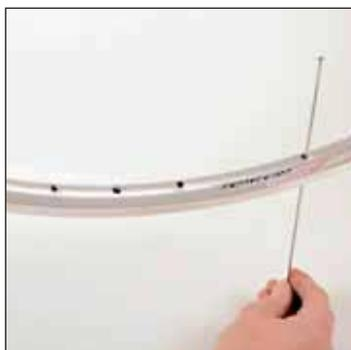
Con il foro valvola vicino a voi, fate passare un raggio, testa per prima, nel secondo foro a destra del foro valvola, poi continuate un foro ogni due
