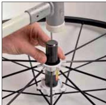
Montate i nuovi cuscinetti utilizzando l'estrattore di montaggio / smontaggio 323 909 01
