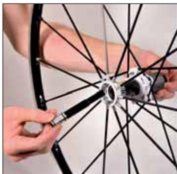
Rimontate il nuovo asse (coppia di serraggio 15Nm)
