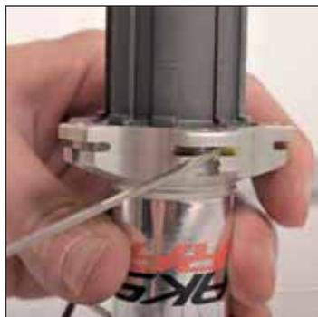
Il 2° raggio a destra del foro valvola è non-trattore e sarà interno : inseritelo nell'alloggiamento del mozzo e fate lo stesso 1 raggio ogni 4
