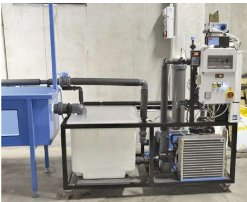
fig. 20 – La parte dedicata al trattamento delle acque del sistema a circuito chiuso.
