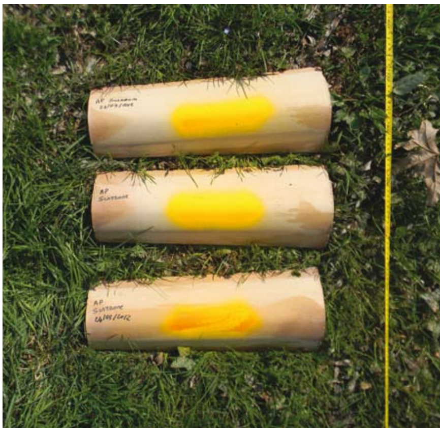
fig. 58 – I coppi utilizzati come substrati per la deposizione in ambiente naturale.
