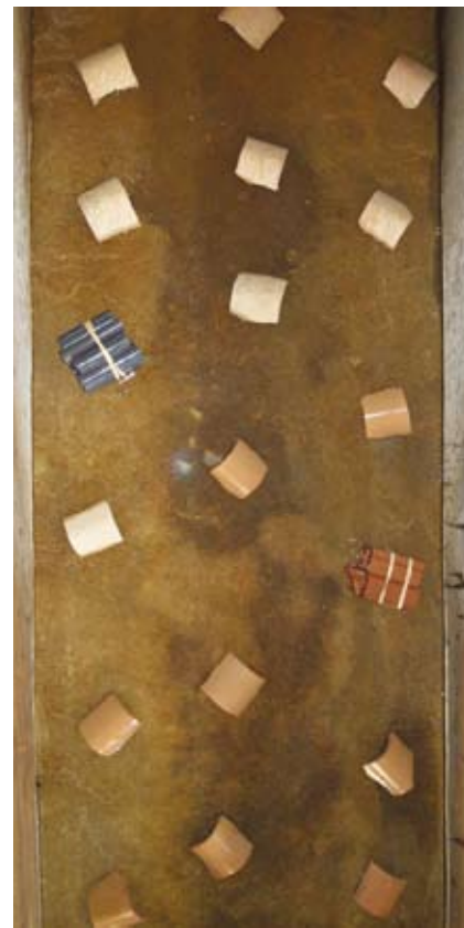
fig. 32 – Vasca allestita per la deposizione, da notare la disposizione regolare dei coppi e la distanza tra loro.
