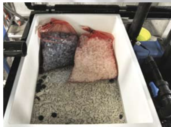
fig. 91 – Filtro biologico con ghiaia corallina e media di plastica.
