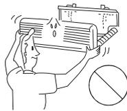
Non installare il climatizzatore in ambienti dove si possono verificare perdite di gas
