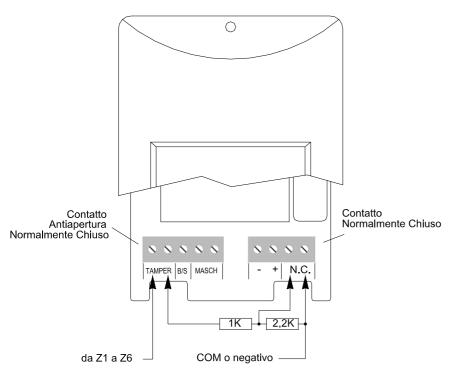
È possibile proteggere liberamente ciascun ingresso anche al taglio e al cortocircuito cavi (protezione contro manomissioni ,TAMPER 24h/24). Per fare questo è necessario programmare l'ingresso di tipo "doppio bilanciamento" e utilizzare le resistenze in dotazione collegandole come da schema seguente:
