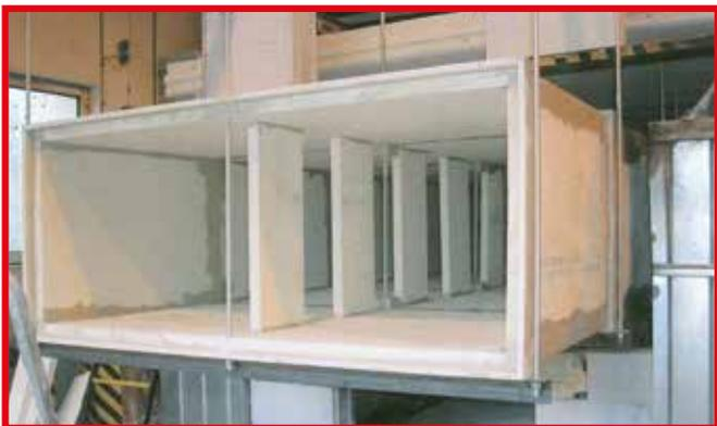
Dopo aver preparato i campioni come sopra indicato, è necessario sottoporli al programma termico normale, come previsto dalla norma UNI-EN 1363-1 (curva standard ISO 834), ricreando un incendio tipo. Nel corso della prova verranno effettuate diverse misurazioni, volte a determinare il momento del guasto, ovvero il punto a partire dal quale il condotto non è più in grado di svolgere la propria funzione e raggiunge la Resistenza definitiva, punto che segna la fine della prova stessa.
