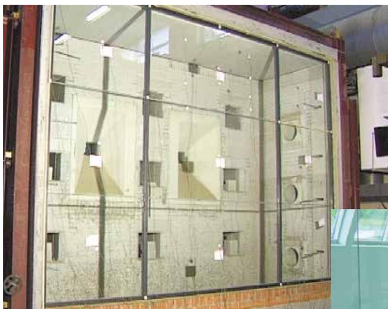
In caso d'incendio il gel intumescente si gonfia creando una schiuma termoisolante rigida ed opaca che garantisce sia la resistenza al fuoco (cioè isolamento termico e tenuta ai gas) sia quella meccanica (stabilità).
