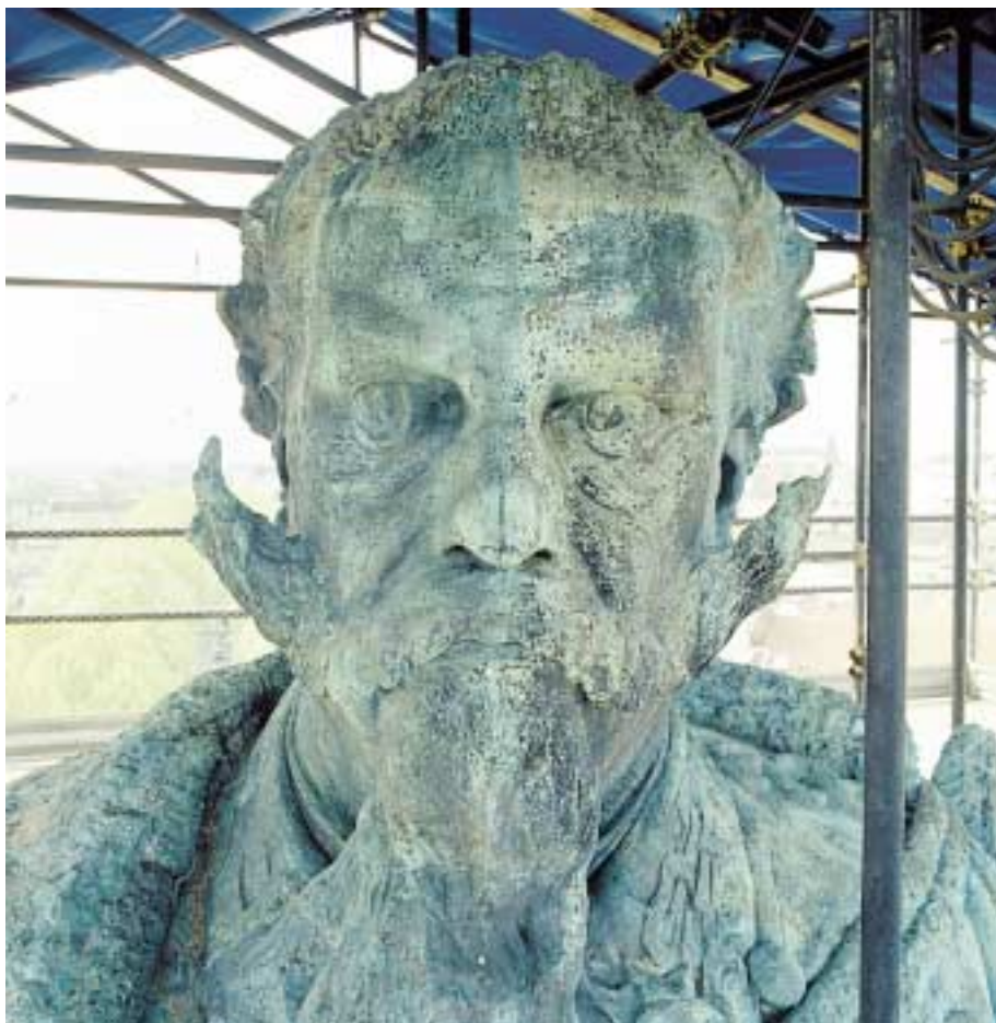
VISIONE DETTAGLIATA DI ALCUNI FENOMENI CORROSIVI DEL BRONZO.
