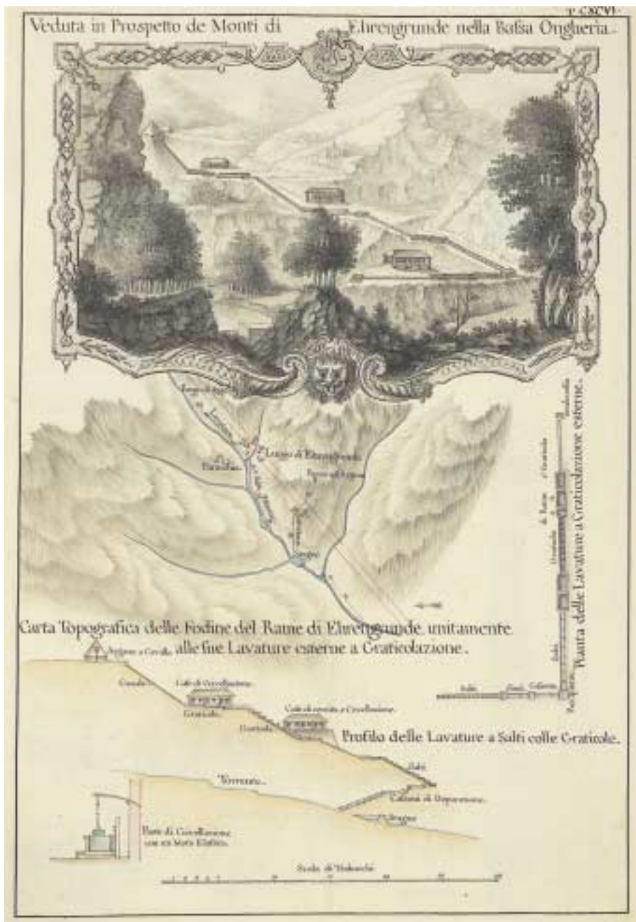
VEDUTA IN PROSPETTO DE' MONTI DI EHRENGRUNDE COLLE LAVATURE, E CERNITE DE' MINERALI IN CASCA- TE, SPACCATO DEL MONTE COLLE LAVATURE; TIPO DI ESSE DI QUELLE CELEBRE MINIERE D'ARGENTO, E DI RAME NELLA BASSA ONGHERIA.
