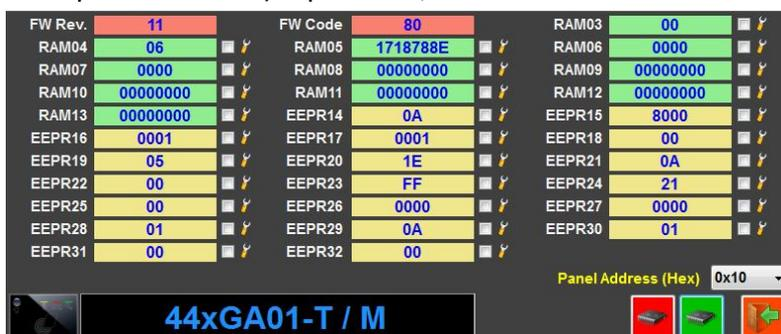
I colori di sfondo dei campi identificano la tipologia di dato riportato. In rosso le variabili in ROM (non modificabili), in verde quelle in RAM (gestite dal lettore esterno) ed in giallo quelle in EEPROM (parametri di configurazione). I valori riportati nei vari campi sono espressi in notazione esadecimale.
