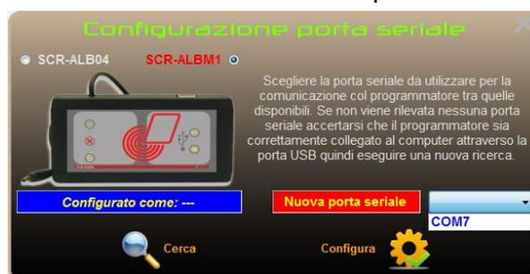
Qualora nella lista non compaia nessuna voce ricontrollare il collegamento del programmatore al computer (verificando il lampeggio del LED giallo con la clessidra) e la corretta installazione dei driver di comunicazione (forniti sul CD di installazione) e quindi fare clic su "Cerca". Dopo aver selezionato dall'elenco proposto la seriale da utilizzare, fare clic su "Configura" per confermare.
