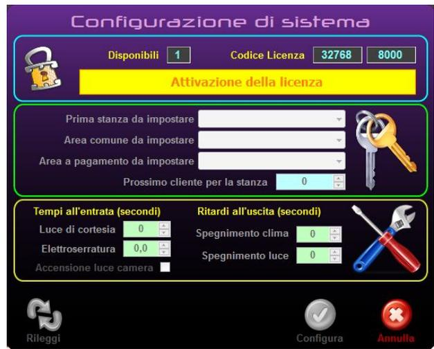
Cliccando sul pulsante "Attivazione della licenza" (evidenziato in giallo al passaggio del mouse come mostrato in figura), viene eseguita la procedura di attivazione della licenza che associa il codice impianto della MASTER al software installato.
