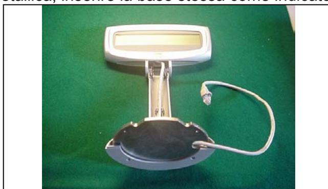
Figura F7.3: Posizionamento cavo e inserimento base metallica
