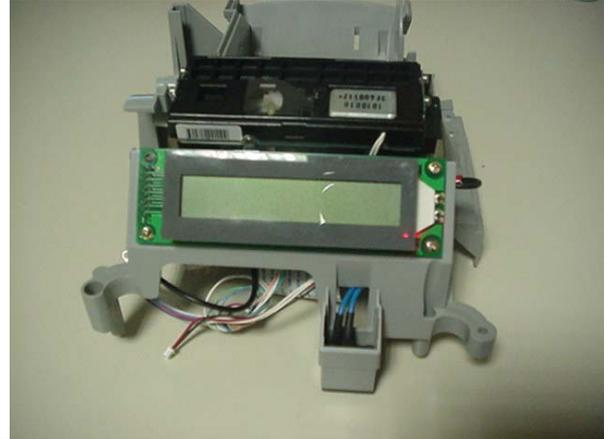
Figura E7.10: Applicare la maschera protettiva sul display e rimuovere il film trasparente
