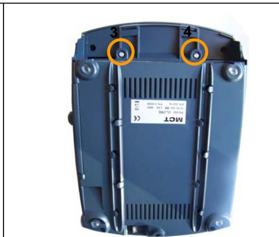
Figura E7.21: Viti di fissaggio posteriori
