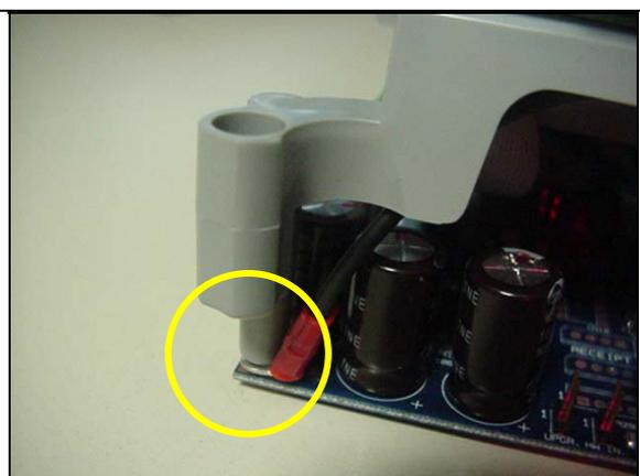
Figura E7.16: Particolare del cavo di massa
