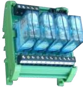
Modulo d'interfaccia passivo a relè che riceve i comandi provenienti da apparecchiature elettroniche quali PLC, PC industriali, Moduli di comando, ecc... e pilota carichi induttivi e resistivi di piccola potenza come: Elettrovalvole, Teleruttori, Piccoli servomotori, Lampade, Resistenze, ecc...
