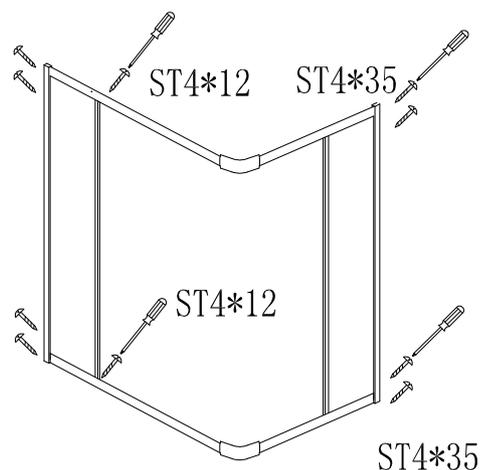
4. Installare la struttura a vetri sulla base, usare viti 4x20 per fissare il pannello posteriore alla struttura della vetrata. Applicare un filo di silicone tra i montanti e le pareti posteriori prima di fissare le viti.
