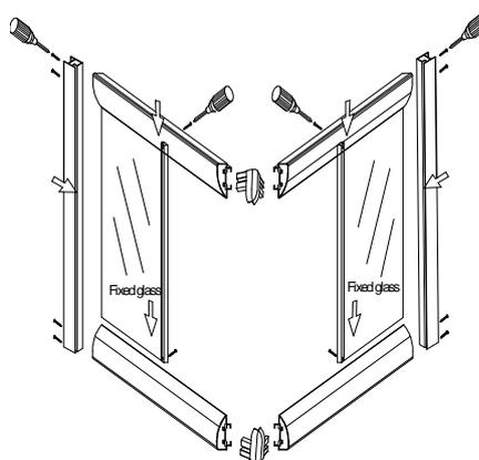
3. Unire poi i due lati destro e sinistro utilizzando i due inserti a "L" in materiale plastico e fissandoli tra i 4 binari, fissandoli con 4 viti autofilettanti.
