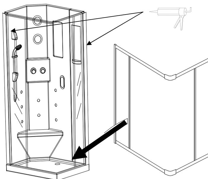
5. Installare le porte scorrevoli. Installare prima le rotelle superiori, poi appenderla alla struttura fissa, poi installare le rotelle inferiori posizionando perfettamente la porta agendo sulle ditine di regolazione (quelle poste in verticale) infine infilare le guarnizioni magnetiche sui bordi dei vetri delle portine in modo che combacino perfettamente una volta chiuse.
