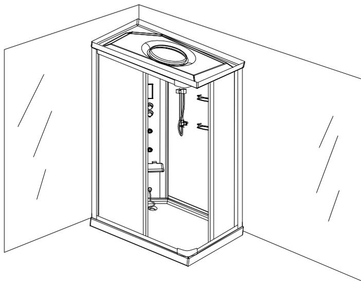
Gli attacchi idrici, si trovano dietro al miscelatore ad una altezza di 120 cm circa, si tenga conto che in ingresso la doccia si collega tramite 2 comuni flessibili (attacco da 1/2 pollice) ai tubi acqua calda e fredda senza particolari predisposizioni. Lo scarico è rialzato rispetto al pavimento di modo da collegarsi allo scarico sul pavimento tramite un comune tubo flessibile. Il prodotto presenta dei collegamenti elettrici consigliamo di collegarli ad una scatola ermetica di grado IP idoneo
