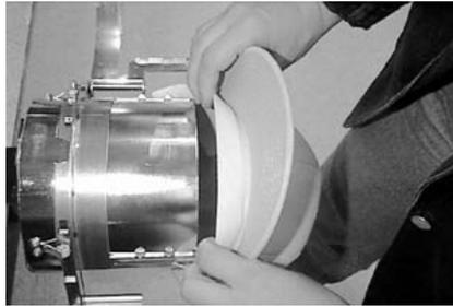
9. Inserite la visiera del cappellino nella scanalatura all'interno della cerniera del telaio cappellini mentre ruotate la cerniera sulla parte anteriore del cappellino.
