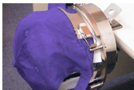
Se la cerniera del telaio cappellini non è stretta a sufficienza – o se è troppo stretta, allentate i due dadi ad alette sul lato sinistro del cappellino e fate scivolare la cerniera in dentro o in fuori secondo necessità prima di stringere nuovamente i dadi ad alette.
