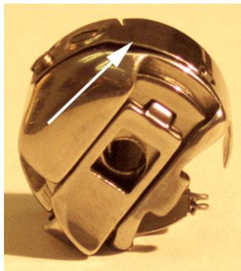
Mentre pulite sotto la molla di tensionamento, fate attenzione a non piegare la molla.
