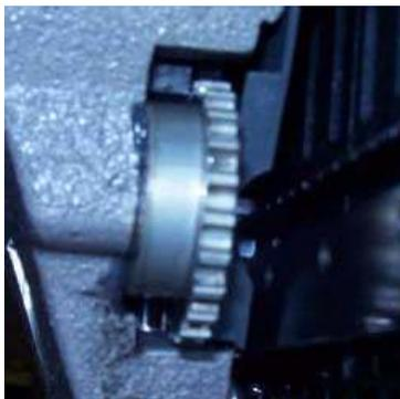
6. Girate la manopola con le dita per regolare l'altezza del premistoffa in alto o in basso secondo necessità. Se impostate l'altezza del premistoffa su una sezione cucita del disegno, allora impostate il premistoffa in modo tale che sfiori appena la cucitura.
