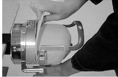
13 . Spingete in basso all'estremità (in alto) della visiera per posizionarla contro la parte superiore alta del supporto del telaio cappellini.
