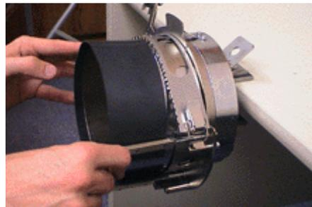
5. Un adeguato supporto può ora essere collocato sull'intelaiatore. Il supporto si trova ESTERNAMENTE ai puntelli delle clips e all'interno della cerniera cilindrica a patte e dei puntelli di serratura. Potete utilizzare parecchi strati di supporto se lo desiderate.
