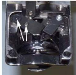
5. Applicate una goccia di olio per macchine da cucire al punto del perno di testa all'estremità inferiore del braccio di comando del coltello come indicato nella figura sottostante. La protezione del perno è stata tolta a scopi illustrativi; tuttavia, potete raggiungere questo punto di lubrificazione senza rimuoverla.
