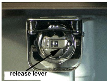
2. Tirate in avanti fino a che l'alloggiamento possa essere estratto dalla macchina. Rimuovete la vecchia bobina dall'alloggiamento.
