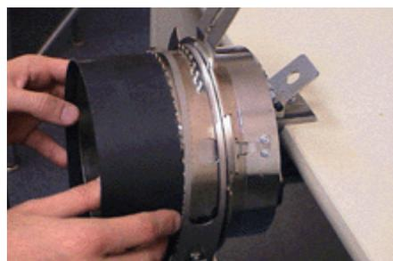
4. ...posizionando le estremità FRA i puntelli delle clips e l'intelaiatore per cappellini.
