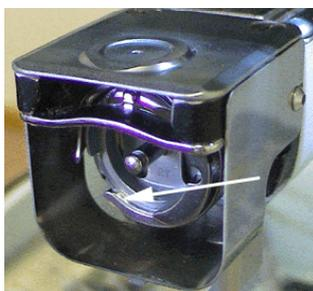
7. Cliccate su **Head Up (Testa su)** nella tabella **Head Timing (Regolazione Testa)** tre volte per ruotare il perno rotatorio e cospargere l'olio tutto intorno all'assemblaggio del perno rotatorio.
