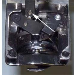
4. Applicate una goccia di olio per macchine da cucire nei due punti del perno di testa del coltello mobile.
