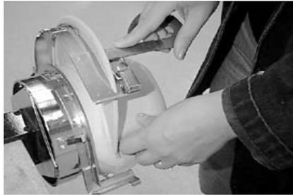
10. Con la cerniera non serrata e ancora libera intorno al cappellino, centrate la parte anteriore del cappellino verso la parte centrale del telaio cappellini.
