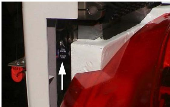
3. Utilizzando aria in bomboletta spray o compressa, togliete sfilacciature di filato e polvere accumulati sul sensore.
