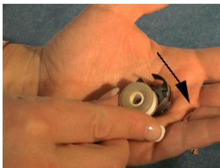
3. Inserite la bobina nell'alloggiamento.
