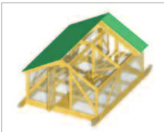
**6. Ricovero-pollaio praticabile: si noti il divisorio interno che può essere realizzato applicando la rete al telaio centrale. La copertura illustrata è realizzata nella variante con tavole e sovrastante impermeabilizzazione**
