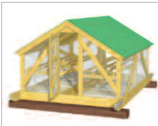
**5. Vista anteriore del ricovero-pollaio accessibile, realizzato su slitta per gli spostamenti. Sono visibili all'interno i posatoi in legno ai due lati della corsia centrale praticabile**
