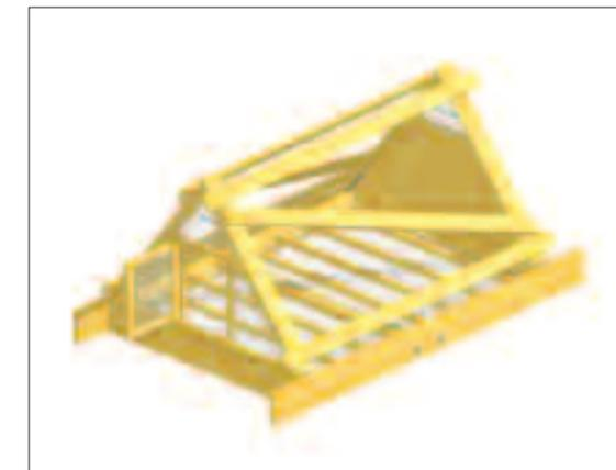
2. Le parti costituenti l'archetta: il telaio di base provvisto di posatoi in legno, il pannello anteriore con l'uscio, in rete metallica, quello posteriore chiuso con tavole, le due falde della copertura di cui si vedono solo i telai portanti con il rinforzo diagonale
