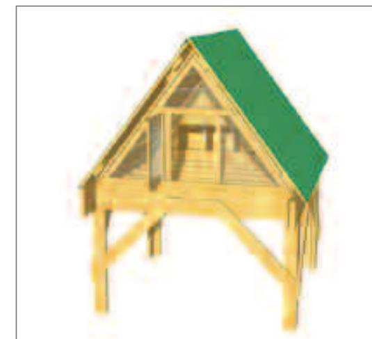
**8. Vista anteriore dell'arca a palafitta per riproduttori, con batteria di nidi applicata posteriormente**
