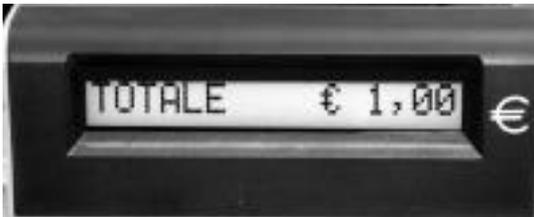
Il Display Cliente a **Torretta Estraibile ed Orientabile** contenente un indicatore tipo LCD alfanumerico e retro illuminato con una linea da 16 caratteri.
