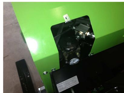
In caso di problemi al circuito del filo comando, tranciamento filo ecc. E' possibile effettuare l'attivazione manuale delle elettrovalvole spingendo con un punteruolo il cilindretto della valvola corrispondente.
