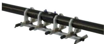
Universal alignment/positioning jig cod. 3851 and Belt positioning jig cod. 3853 Allineatore/posizionatore universale cod. 3851 e Posizionatore a cinghie cod. 3853 Alineador/posicionador universal cod. 3851 y Posicionador de correas cod. 3853
