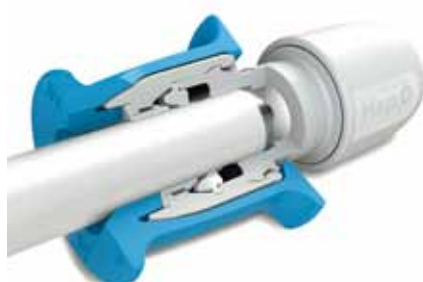
Fig. 26 Vista in sezione di HepKey Plus™.
