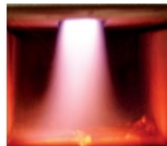
Completa combustione dei gas della legna nella camera inferiore
