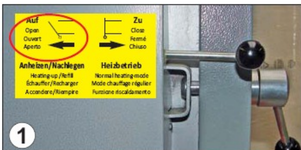
1 Posizionare la leva della valvola di accensione in posizione "Anheizen"/"AUF"
