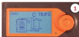
Display grafico con schema idraulico Solarbayer predefinito
