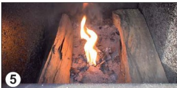
5 Appoggiare due ceppi di legno alle pareti destra e sinistra della camera di combustione della caldaia
