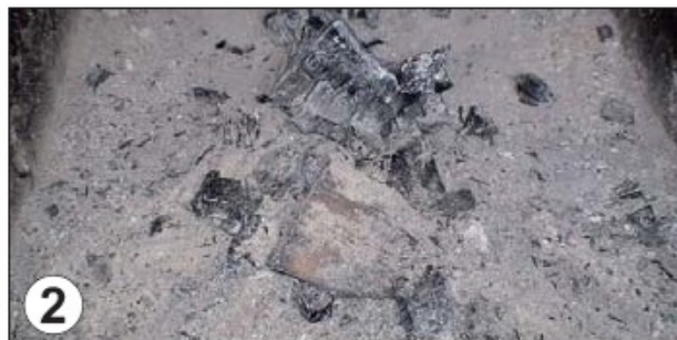
2 Posizionare i residui dell'ultima combustione sopra l'ugello del bruciatore.
