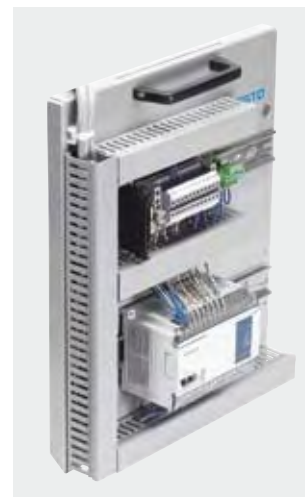
Pannello PLC con controllore programmabile Mitsubishi mod. Melsec FX1N
