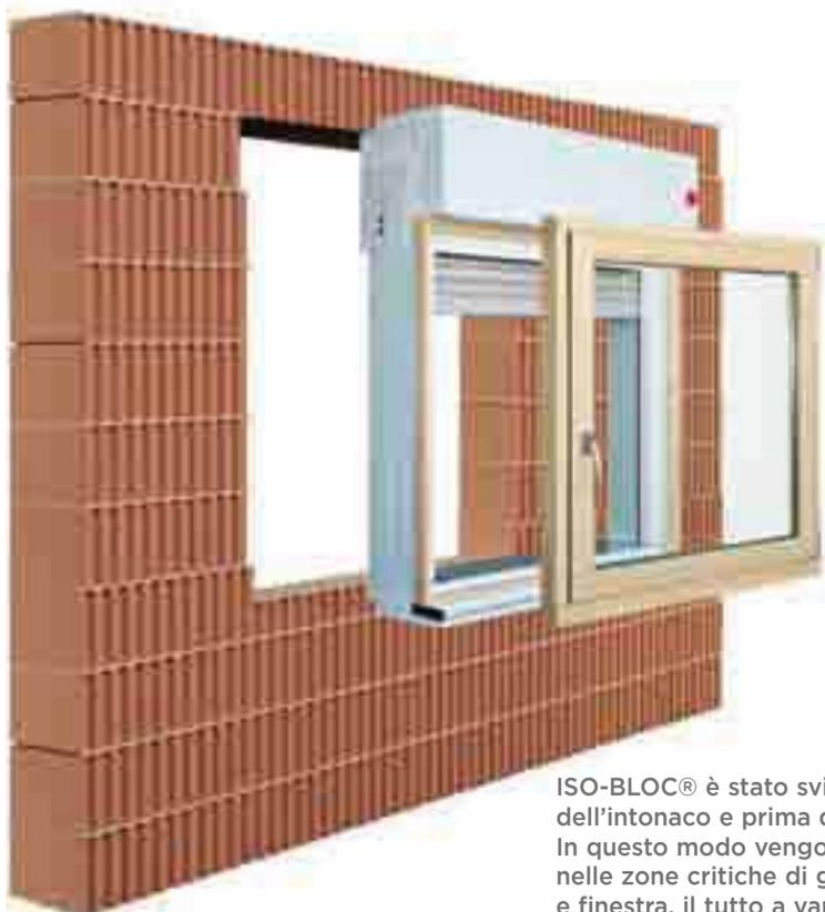
ISO-BLOC® è stato sviluppato per essere montato prima dell'intonaco e prima dell'applicazione dell'isolamento termico. In questo modo vengono evitati ed eliminati tutti ponti termici nelle zone critiche di giunzione, tra telaio e muro, tra muro e finestra, il tutto a vantaggio di un isolamento termico ottimale
