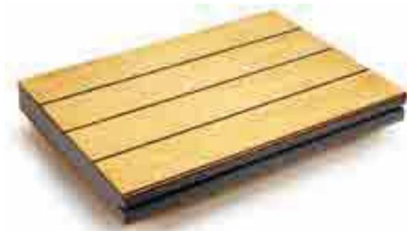
LARIPAN® Xe: un'evoluzione del pannello composito per la realizzazione di coperture termoisolante, che, grazie all'innovativo inserto in polistirene espanso estruso, offre un'elevata efficienza energetica con minori spessori. Produzione Bellotti
