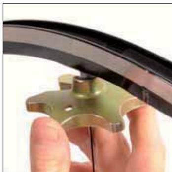
Effettuate la tensionatura e la centratura definitiva della ruota rispettando i valori di tensione dei raggi indicati nelle pagine prodotto.
