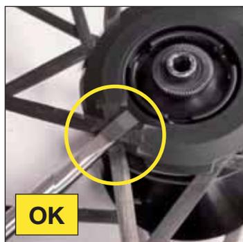
Inserite un cacciavite piatto (idealmente 5x 125 mm) all'interno di un'apertura a livello dell'incrocio di due raggi, spingetelo finché la punta del cacciavite vada in battuta con il corpo del mozzo.
