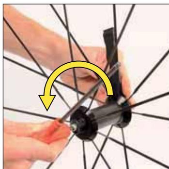
Svitate l'asse girando la chiave a brugola in senso antiorario. Effettuate circa 5 giri completi per allentare sufficientemente.
