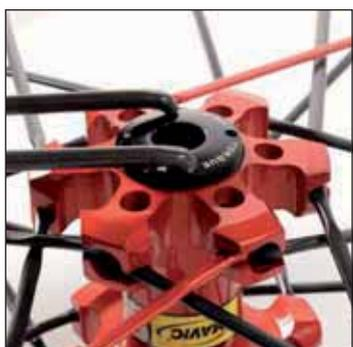
Rimontate il tappo di protezione del cuscinetto con una chiave a piolini (coppia 9 Nm).
