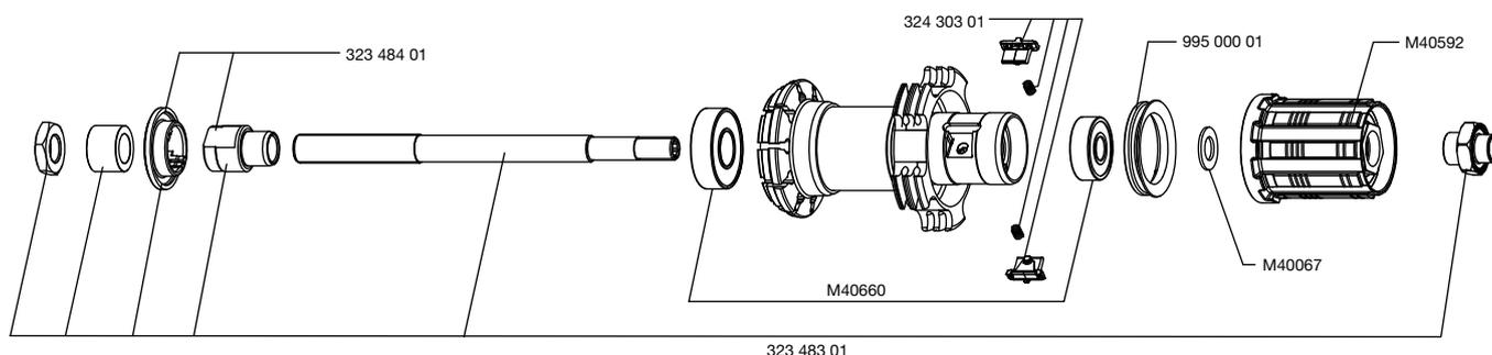
Essendo il mozzo anteriore in 3 parti ed il posteriore in 2, le operazioni di manutenzione dei mozzi (sostituzione dell'asse o dei cuscinetti) devono sempre essere effettuate con la ruota montata (mozzo, cerchio e raggi assemblati).
