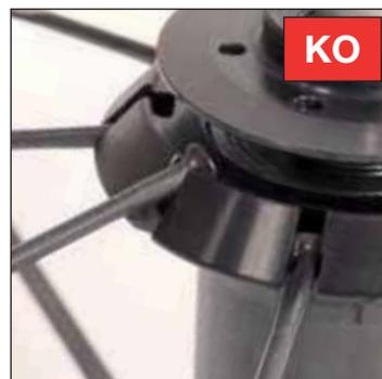
Ripetete quest'ultima operazione per i raggi sull'altro lato. Avvitare ciascun nipples in modo uniforme (1 giro di chiave per raggi per ciascun raggio per ogni giro di ruota) per mettere la ruota in tensione, verificando il corretto posizionamento delle teste dei raggi all'interno della gola del mozzo per prevenire qualsiasi sganciamento del raggio o danno del mozzo.
