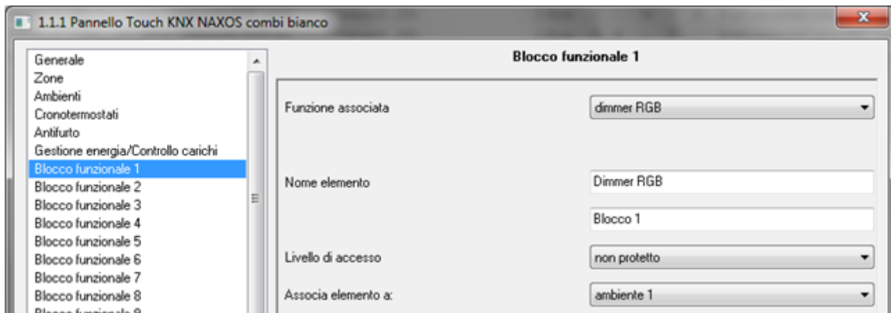
Fig 9: Impostazione parametri ETS - Sezione "Funzione dimmer RGB"
