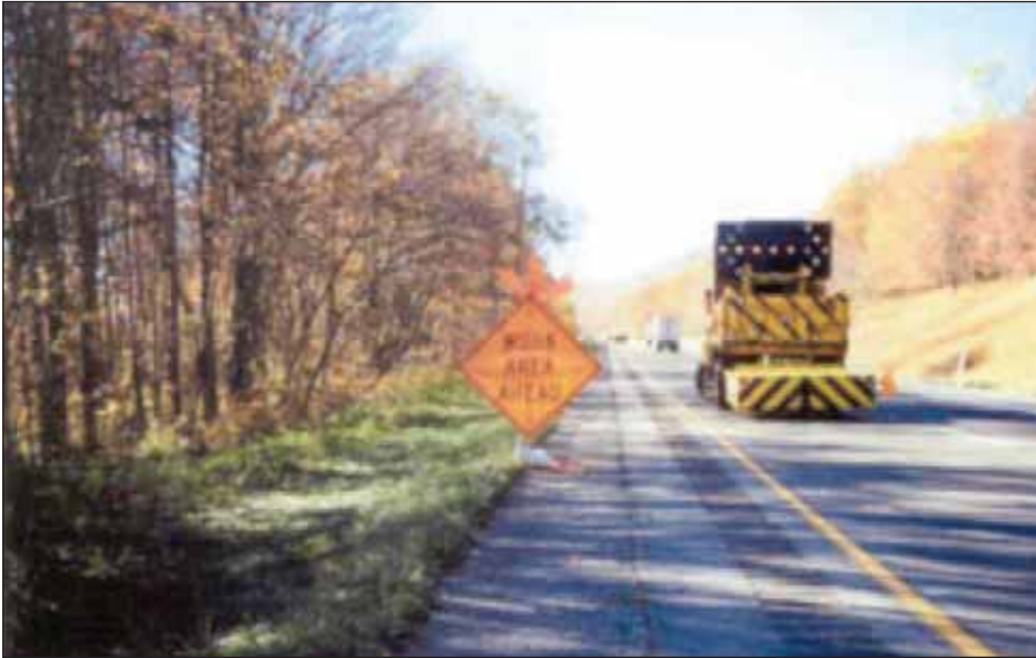
Foto 2 - Autocarro equipaggiato con il TMA (attenuatore d'urto) e con il segnale con la freccia luminosa.
