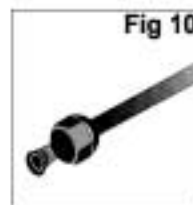
Fig. 10 Per prevenire fughe di refrigerante è bene unire le filettature con olio di refrigerazione
