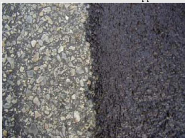
Particolare di asfalto tipo Splittmastix
