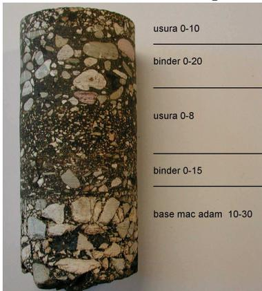
I carotaggi vengono eseguiti su pavimentazioni appena messe in opera per controllarne le caratteristiche e metterle a confronto con i capitolati d'appalto, su pavimentazioni esistenti o terreni, analizzandone composizione e caratteristiche, per ottenere informazioni per interventi da programmare.
