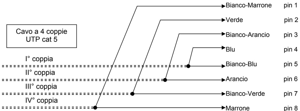
Collegare le coppie ai connettori in questa maniera (rispettando lo standard di connessione del cavo patch UTP di rete lan) permette di sfruttare al meglio le coppie twistate che mantengono il più possibile l'integrità e l'immunità del segnale trasportato rispetto ad eventuali disturbi elettrici.
