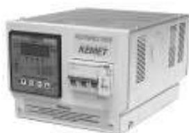
Il modulo di comando C94SM è progettato per per il rifasamento di impianti elettrici in Bassa Tensione. Questo dispositivo, gestendo fino a 3 o quattro batterie trifase della serie C88H, è ideale per il rifasamento di piccole utenze. Il montaggio richiede una serie di accessori tutti già forniti con l'apparecchiatura. (TA escluso)
