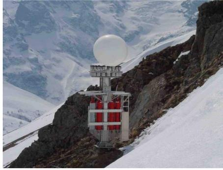
Figura 3.18: Avalhex con un pallone pronto per la detonazione.
