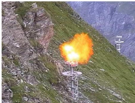
Figura 3.19: L'esplosione della miscela gassosa in un pallone del sistema Avalhex.
