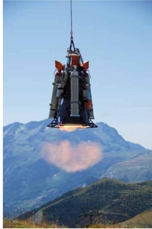
Figura 3.15: L'esplosione della miscela gassosa nella campana del sistema Daisybell collegato al gancio baricentrico dell'elicottero.
