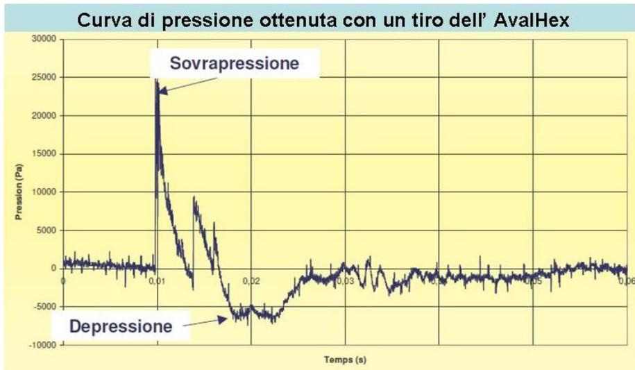
Figura 3.17: Grafico dell'onda di pressione prodotta da un'esplosione innescata dal sistema Avalhex.
