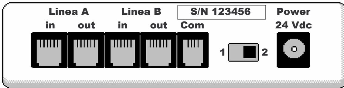
**Linea A - in** = Connettore RJ a 6 poli per la connessione della prima linea telefonica del sistema. Sono utilizzati i due contatti centrali ovvero i due fili più interni di un cavetto telefonico standard. Rappresentando simbolicamente i sei punti del connettore, le x rappresentano i due punti da connettere "o o x x o o". Questa linea è quella dove connettere l'eventuale linea dotata di servizio CLI per il riconoscimento del numero del chiamante.
