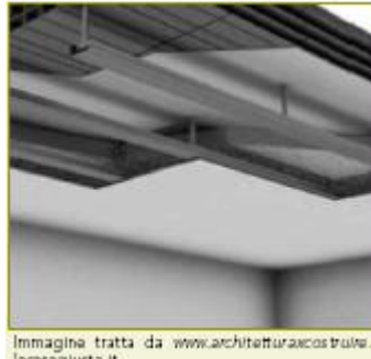
FIGURA 5 - Isolamento acustico a soffitto.
