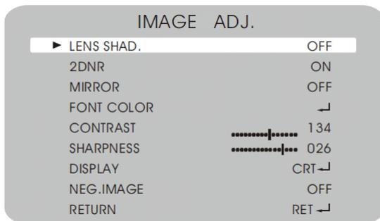
**Lens Shad.**: funzione di compensazione della luce laterale (ON-OFF).
