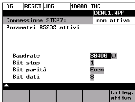
Fig. 7-16 Collegamento a S7-200
